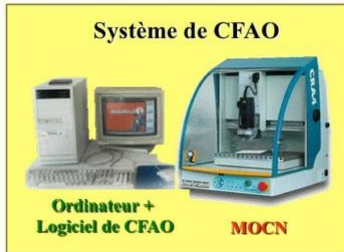
La MOCN est une fraiseuse à commande numérique. Elle **est pilotée par un ordinateur et son logiciel** et son logiciel de CFAO.
