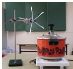
Dispositif de production de vapeur
