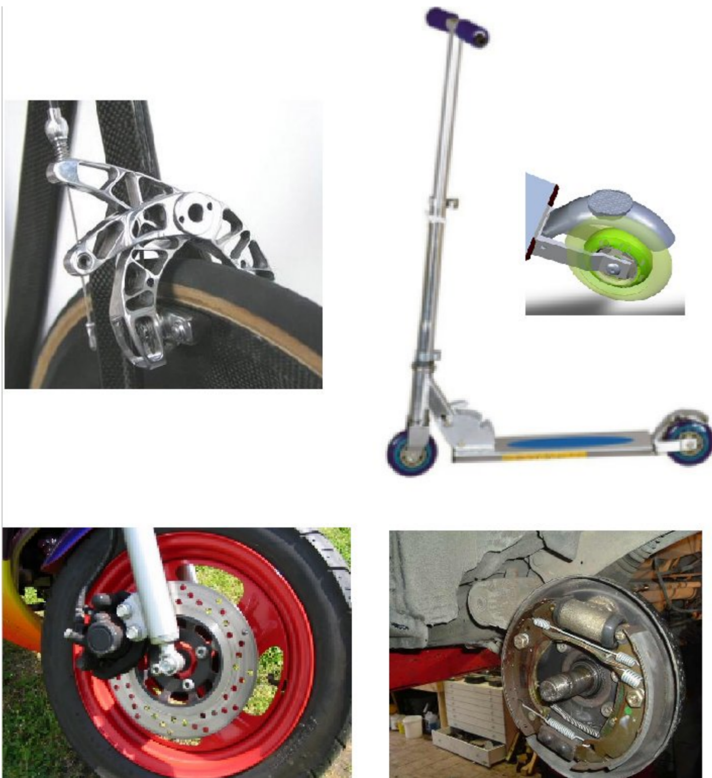
Exemples de freins à disque sur un vélo (haut gauche) et un scooter (bas gauche) et d'un frein à tambour sur une trottinette (haut droite) et une roue arrière de voiture (bas droite).
