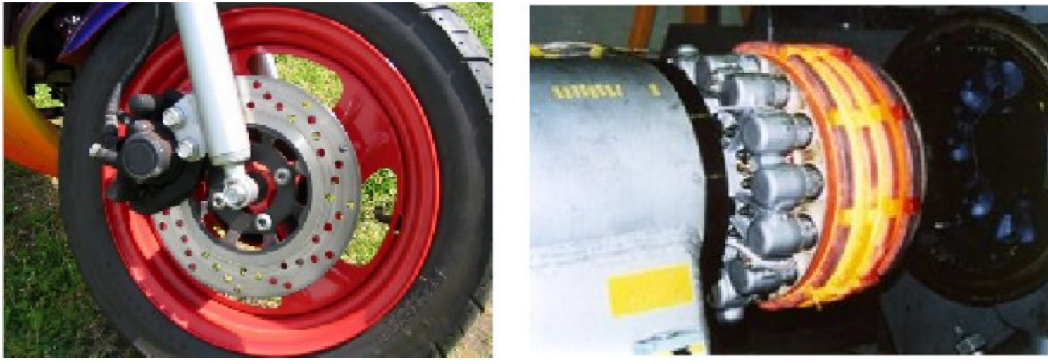
Illustration des trous d'aération des freins à disques d'un scooter (à gauche) et de la tenue à la température des matériaux utilisés dans les freins des gros avions (à droite).
